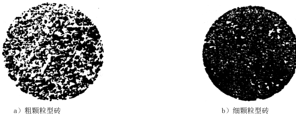
图 2 合格试样的复写纸印痕
