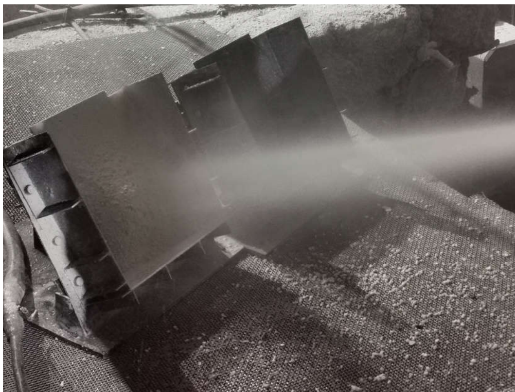
图 1 喷射成型示意图
