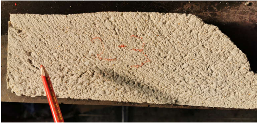
图 6 加工切面中的裂缝
