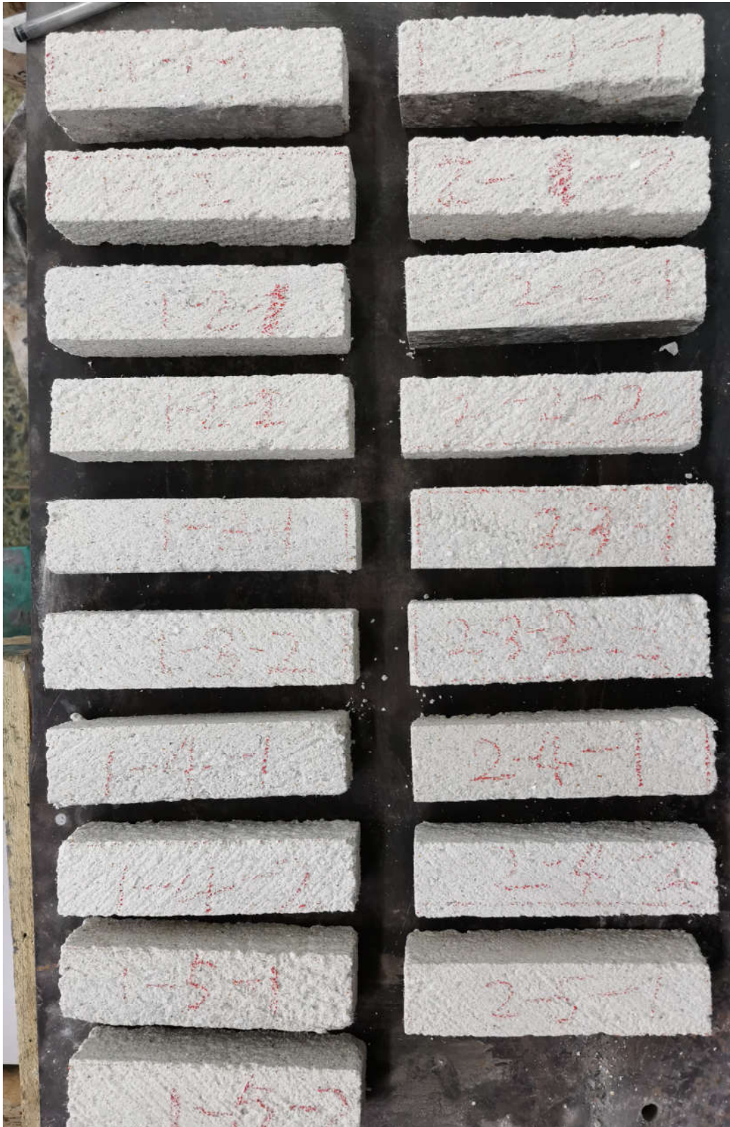
图 5 大试块加工成的 (40×40×160) mm 试样
