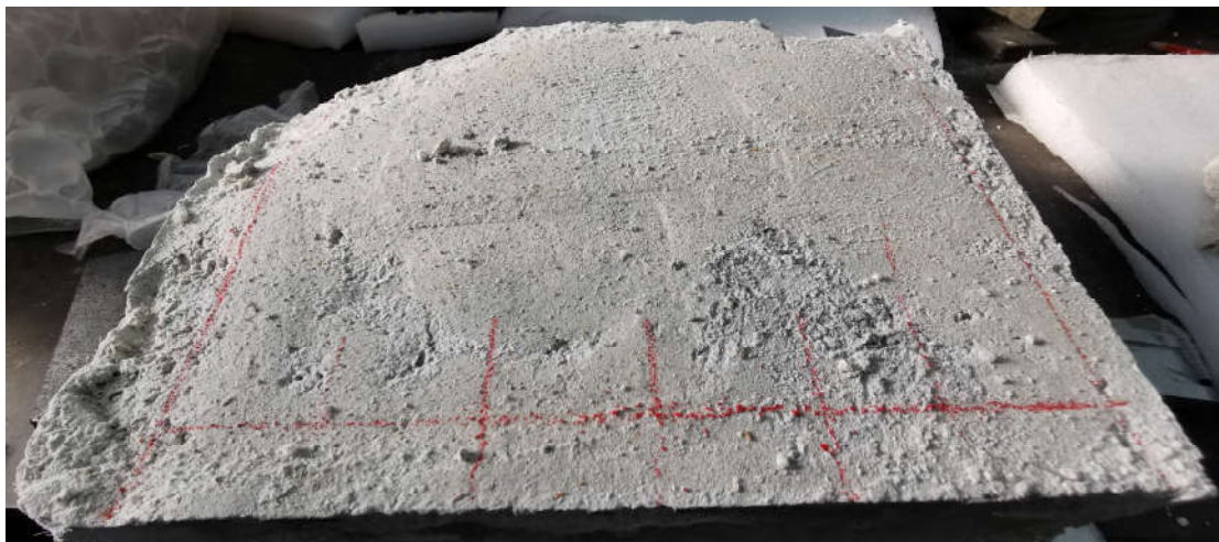
图4 喷射成型制备的钢包喷补料试块（ 300\times 300\times 100 ）mm
